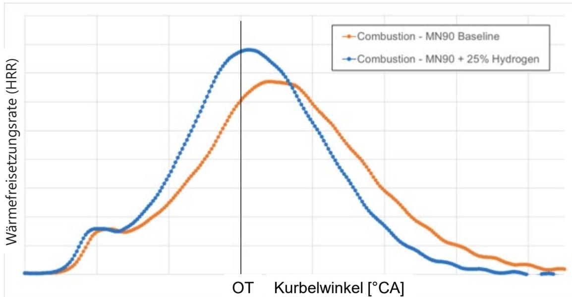
H<sub>2</sub> Zumischung zu Erdgas bei **konstanten** Motorparametern führt zu:
