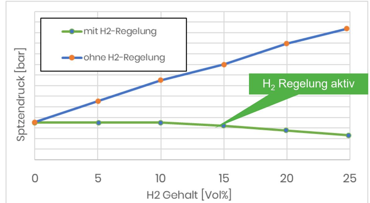
Mittels H<sub>2</sub> Signal und NO<sub>x</sub> Sensor können NO<sub>x</sub> Emissionen & die mechanische Belastung ausgeregelt werden
